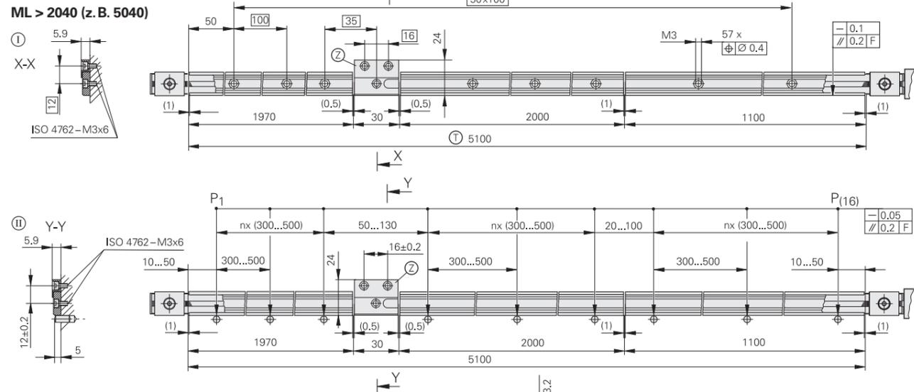
Montagemöglichkeiten des Abtastkopfes
