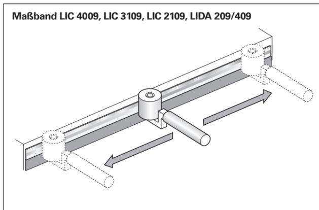
Da die offenen Längenmessgeräte an der Maschine aufgebaut werden, ist nach der Montage ein exakter Abgleich notwendig, der die endgültige Genauigkeit des Messgeräts entscheidend bestimmt. Es ist deshalb zweckmäßig, durch die Konstruktion der Maschine die Justage einerseits so einfach und praktikabel wie möglich zu gestalten, andererseits auf möglichst stabilen Aufbau zu gewährleisten.
