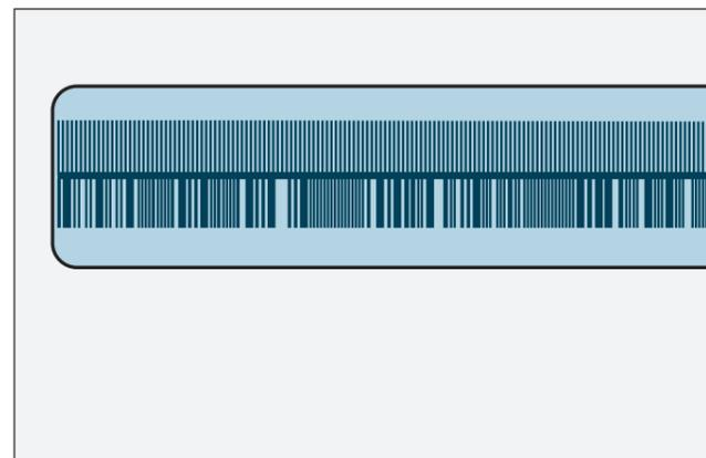
Schematische Darstellung einer Codestruktur mit zusätzlicher Inkrementalspur (Beispiel für LIC 411x)
