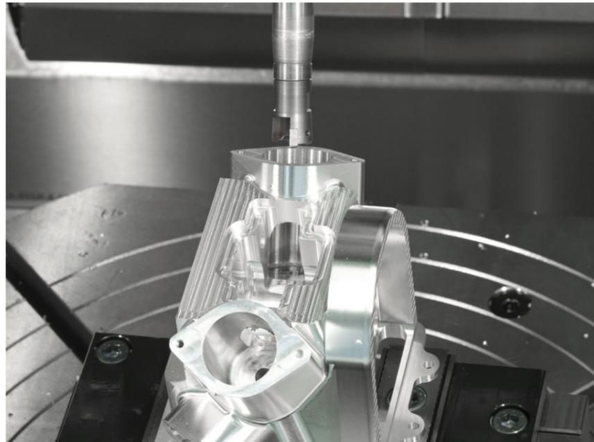
Auch das Positionierverhalten beim Einschwenken können Sie mit der PLANE-Funktion festlegen, damit beim Abarbeiten des Programms keine Überraschungen entstehen. Die Einstellungen für das Positionierverhalten sind bei allen PLANE-Funktionen identisch und erleichtern so die Handhabung erheblich.
