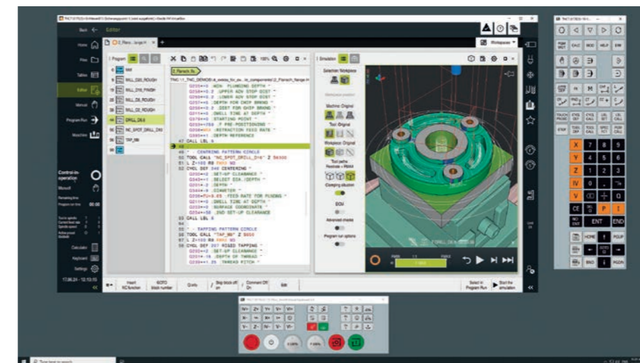
Stazione di programmazione con tastiera virtuale
