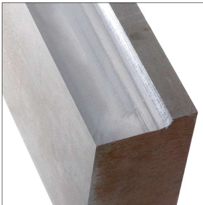
Pezzo fresato con ACC: con stesso avanzamento e medesima profondità di taglio la superficie non presenta rigature da vibrazioni. La lavorazione è stata eseguita salvaguardando l'utensile e la macchina.
