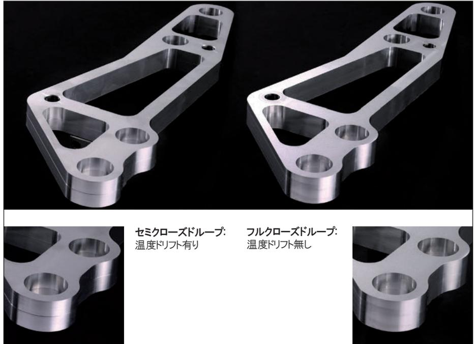
図6 結合レバー:同じ形状を2度加工した例
